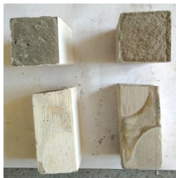
Рис. 7 – Излом образцов, подвергшихся воздействию кислотного состава
