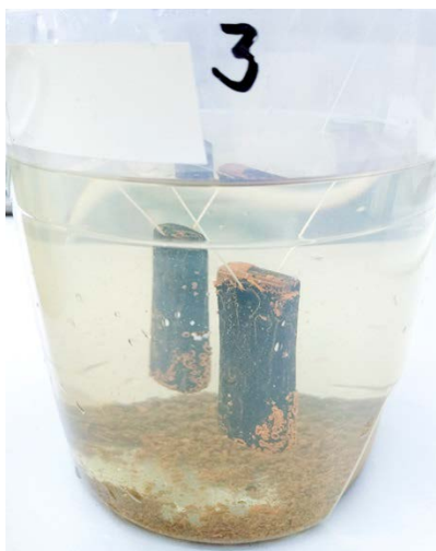
Рис. 12 – Образцы с продуктами коррозии
