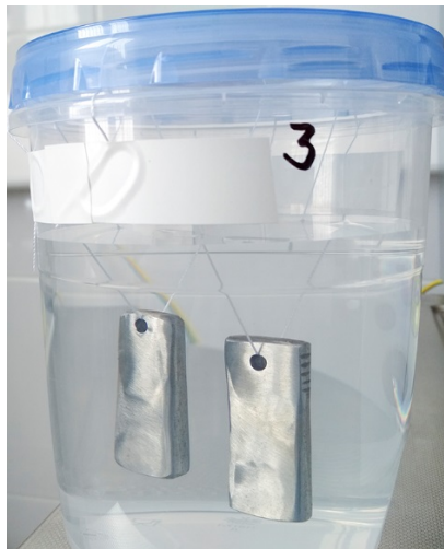
Рис. 10 – Размещение образцов в коррозионной среде
