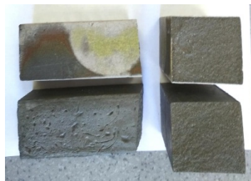
Рис. 8 – Сопоставление образцов, подвергшихся воздействию кислотного состава (сверху) и нет (снизу)
