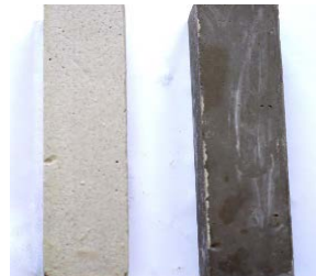
Рис. 4 – Внешний вид образца, подвергшегося воздействию кислотного состава (слева) и выдержанного в воде (справа)
