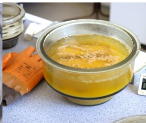
Рис. 3 – Образцы, после 2-х часов выдерживания в кислотном составе
