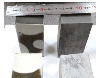
Рис. 9 – Сопоставление образцов, подвергшихся воздействию кислотного состава (слева) и нет (справа)
