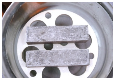
Рис. 2 – Исходные образцы, подвергшиеся воздействию кислотного состава
