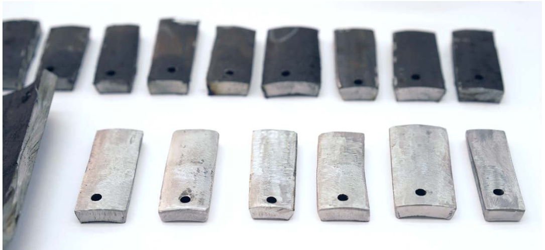
Рис. 4 – Зачистка образцов от следов коррозии
