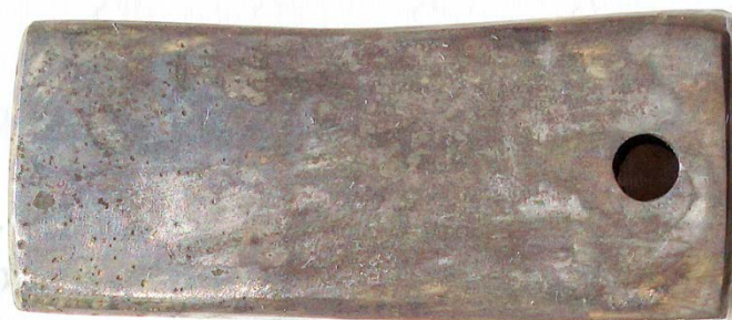
Рис. 14 – Образец, выдержанный в дистиллированной воде, после очистки от продуктов коррозии
