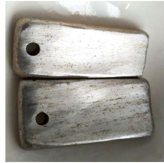
Рис. 8 – Появление следов коррозии
