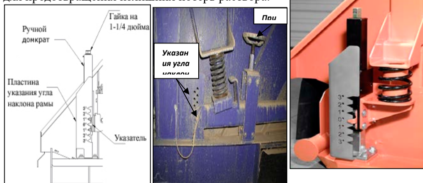
Рис. 3. Примеры регулировки угла наклона виброрама (Mongoose справа и слева, Brand “Cobra” в середине)
