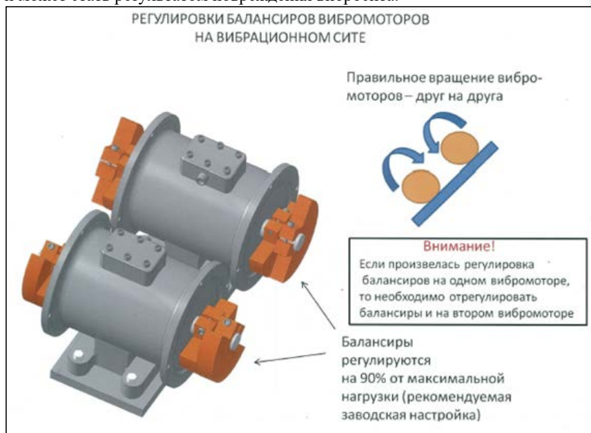
Рис. 5. Регулировка балансиров вибромоторов на вибрационном сите.
