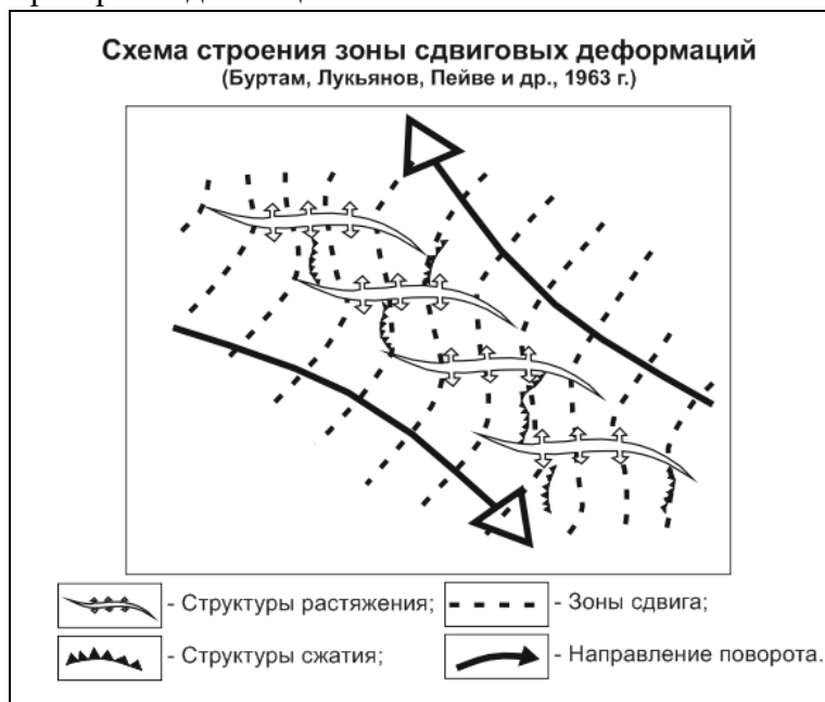
Рис. 4. Схема возникновения «закручивания» в районах сдвиговой деформации.
