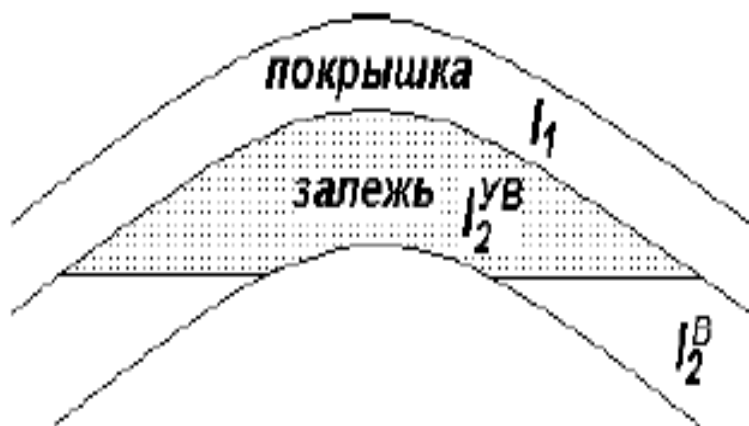
Рис.1. Модель, поясняющая возникновение на сейсмических разрезах разрезах амплитудных аномалий, связанных с залежами УВ.
