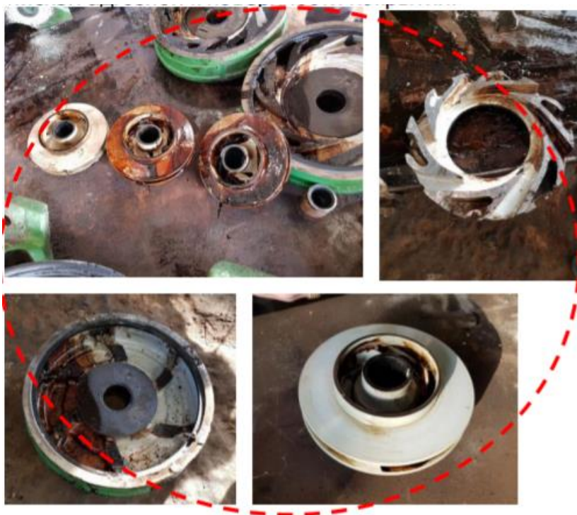
Рисунок 4 - Внешний вид деталей насоса с полимерным покрытием
