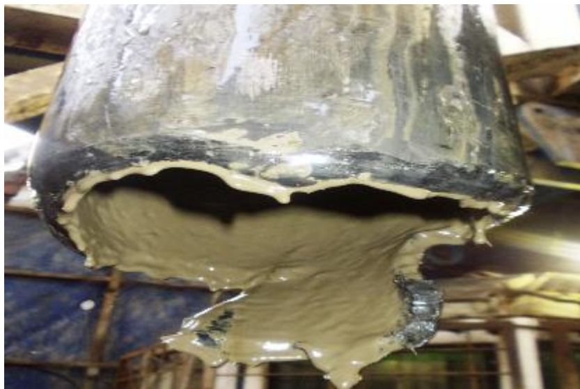
Рисунок 3 - Инструмент после торпедирования
