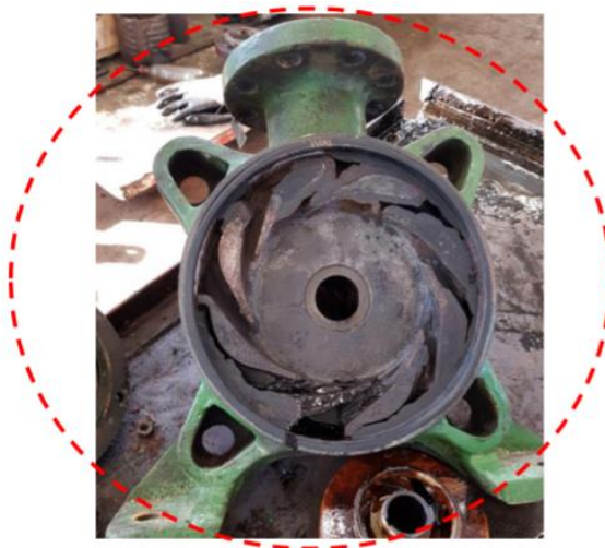
Рисунок 5 - Отложения на напорной крышке насоса без полимерного покрытия
