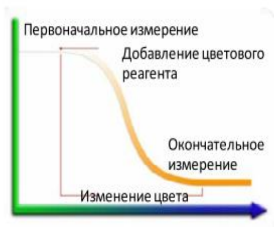
Рисунок 8 - Цикл работы поточного анализатора
