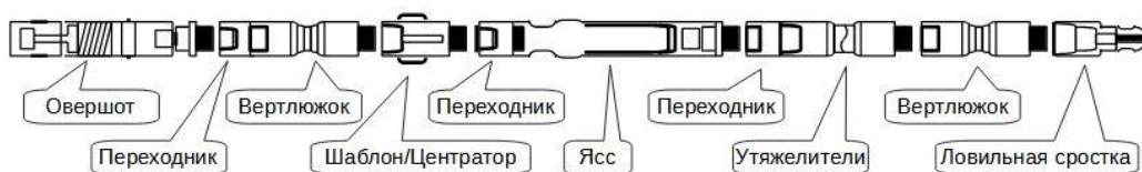
Рисунок1 - Схема ловильного оборудования
