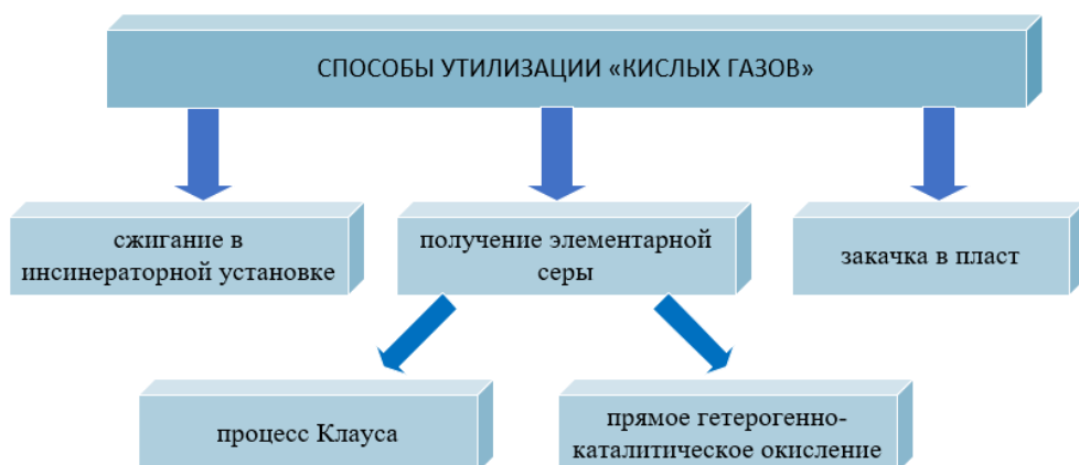
Рисунок 2 - Основные способы утилизации «кислых» газов
