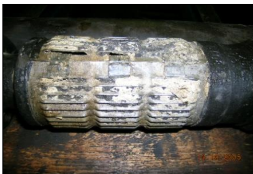
Рисунок 2 - Засорение приемной сетки
