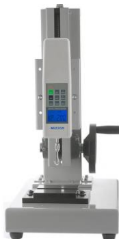
Рисунок 1 - Внешний вид испытательного динамометрического стенда для измерения прочности гелей (Мегеон 03000D)
