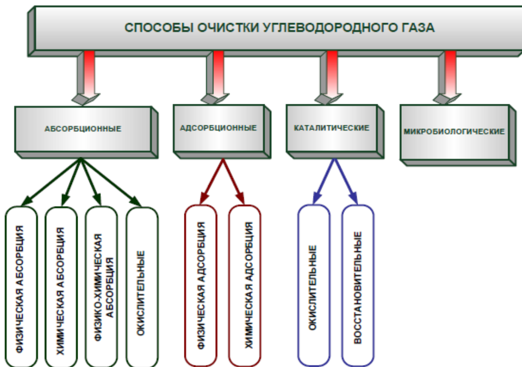
Рисунок 1 - Основные способы очистки углеводородного газа
