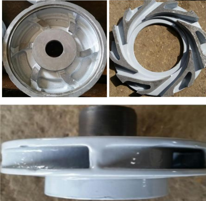
Рисунок 3 - Внешний вид деталей насоса после нанесения полимерного покрытия
