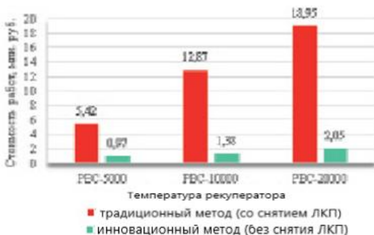
Рисунок 4 - Сравнение стоимости проведения комплексной диагностики РВС для заказчика традиционным и инновационным методами
