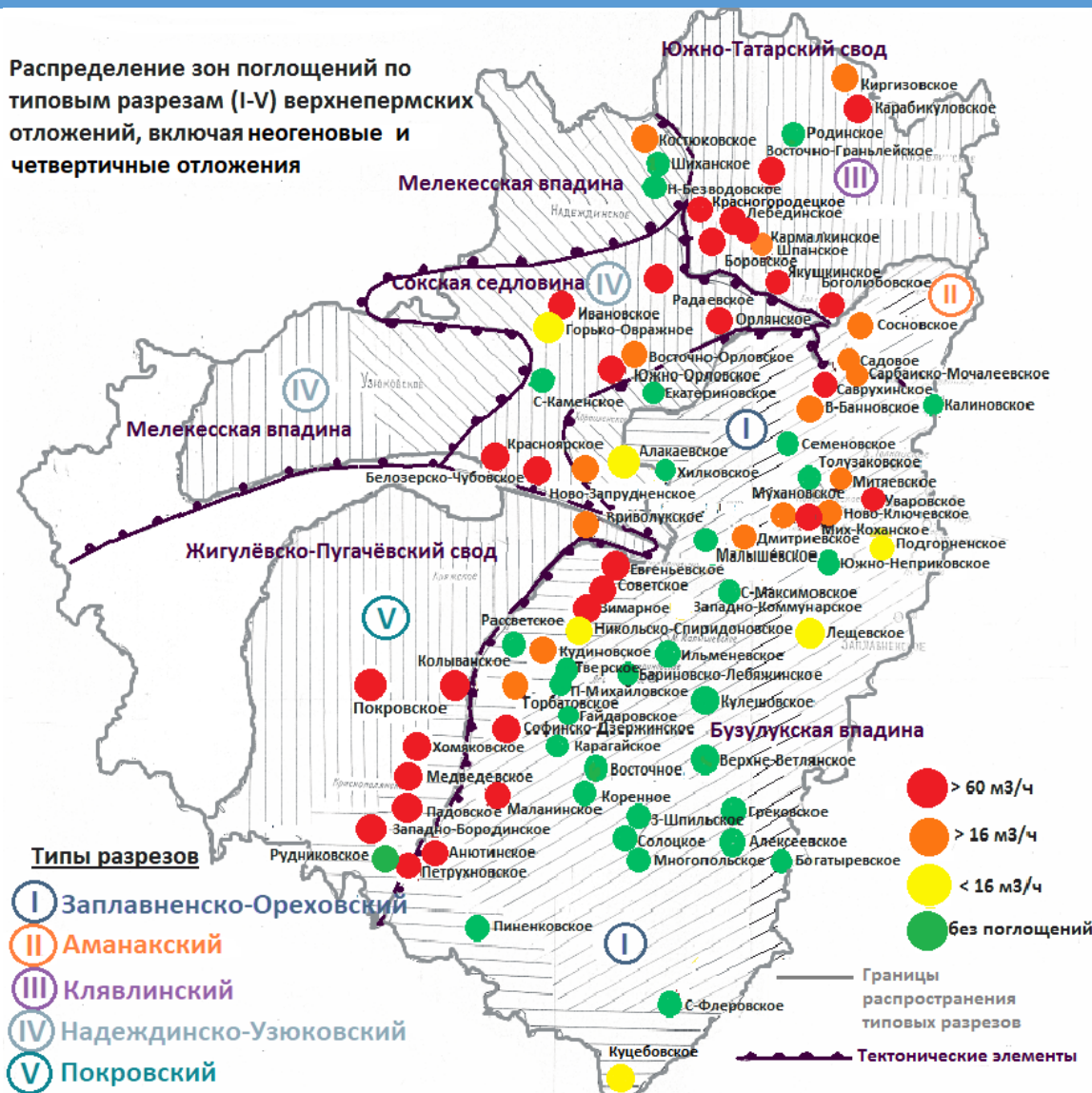
Рис. 3 – Территориальное распределение зон поглощений по интенсивности в привязке к тектоническим элементам ( P_2 + P_3 + N + Q )
