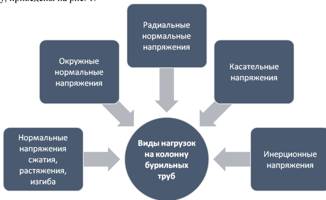
Рис. 1 - Основные типы нагрузок, действующих на колонну бурильных труб.
