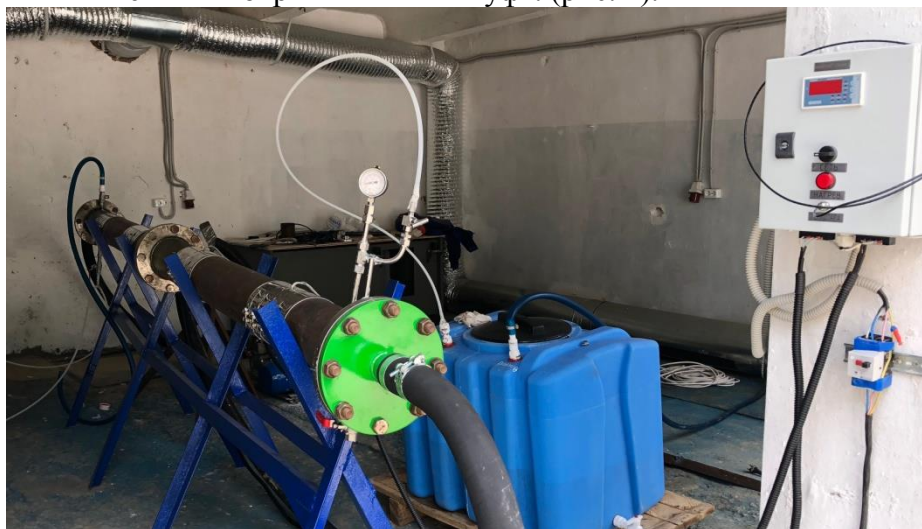
Рис.1 Циркулирующий стенд имитации процессов коррозии
