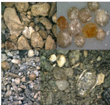
Рис 4. Шлам неизменной породы пласта А4 башкирского яруса. Известняк серого с бурым иногда светло-кремовым оттенком, цвета, биосфераагрегатный (частично псевдооолитовый) мелкозернистый пористый, средней крепости.
