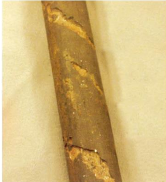
Рис.1. Типичное повреждение трубопровода под воздействием низкосортных включений
