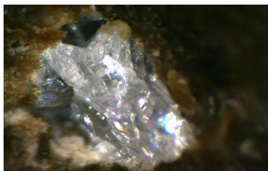
Рис 2. вторичная сульфатная минерализация стенок микрокаверн в известняке
