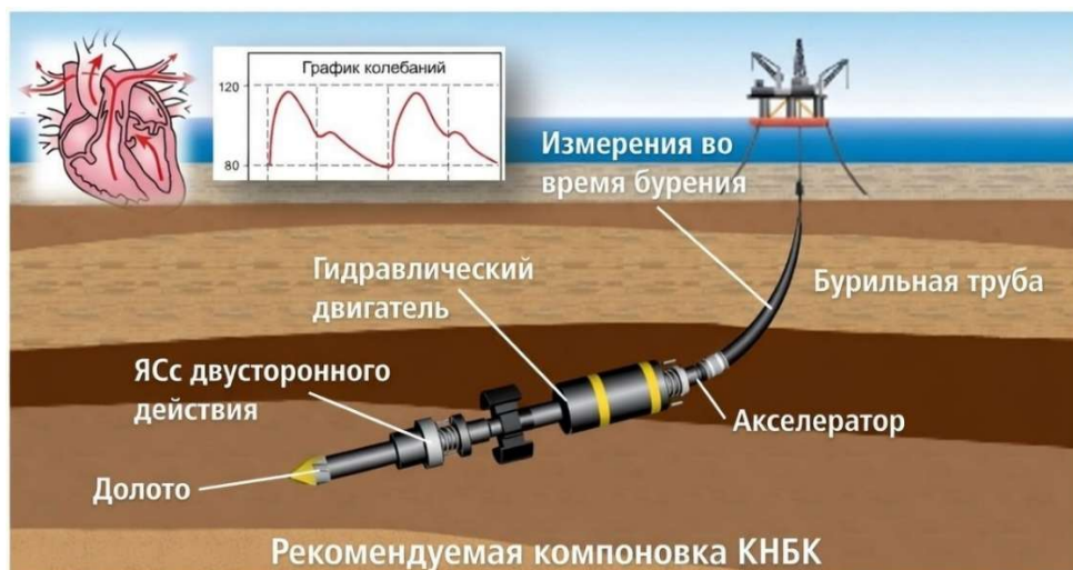
Схема размещения ясса двустороннего действия и акселератора в компоновке низа бурильной колонны для условий Ивановской площади.
