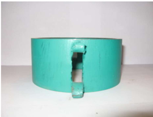
Рис. 3. Фрагмент обсадной трубы с отверстием, сформированным ПГМ
