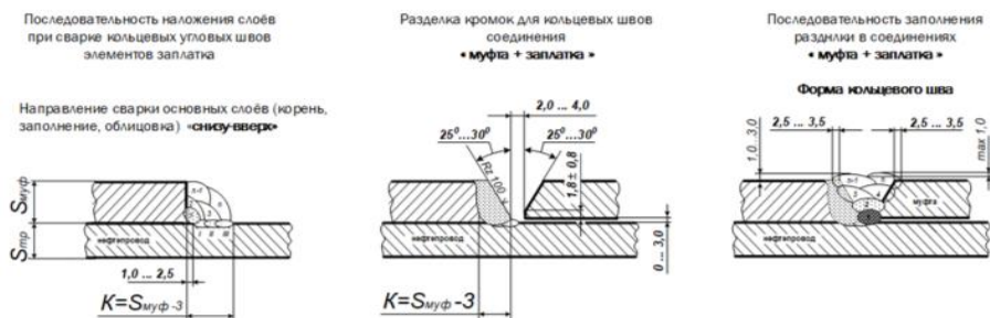
Рисунок 3.2. Технологическая карта сварки ремонтной металлической заплаты
