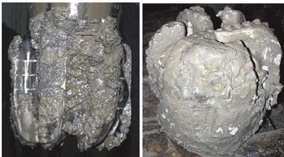
Рисунок 1 – Образование сальника на долоте
