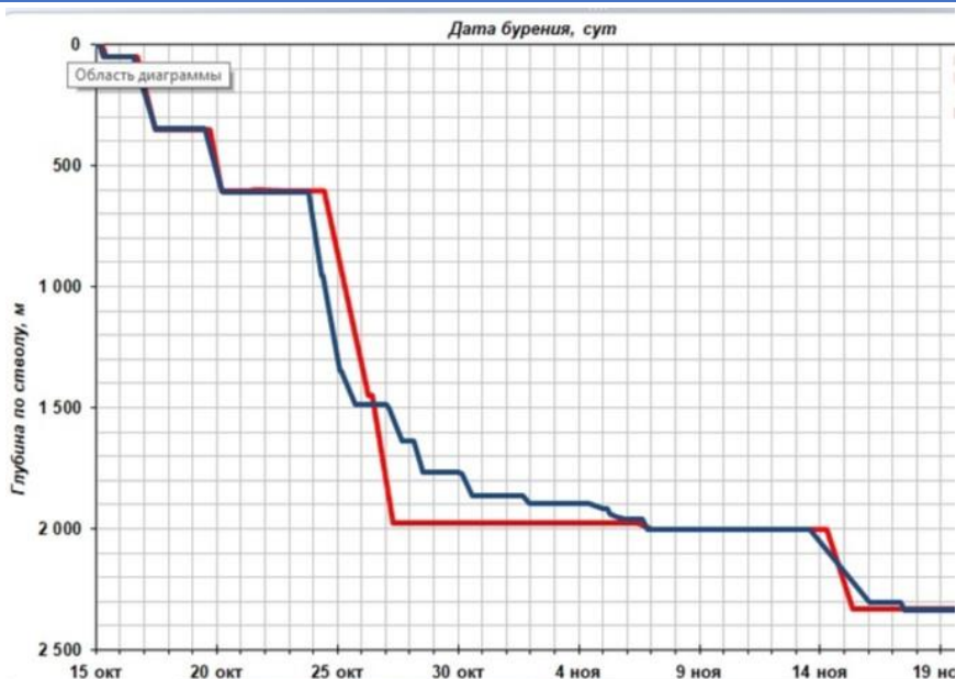
Рисунок 3 – График строительства скважины. Красный – нарисован плановый график бурения скважины. Синий – нарисован фактический график бурения скважины.
