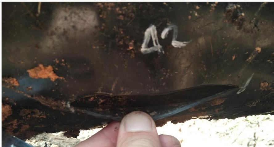
Рисунок 3 фото дефекта - повреждение и полное отслоение термоусадочной манжеты по всей площади сварного соединения
