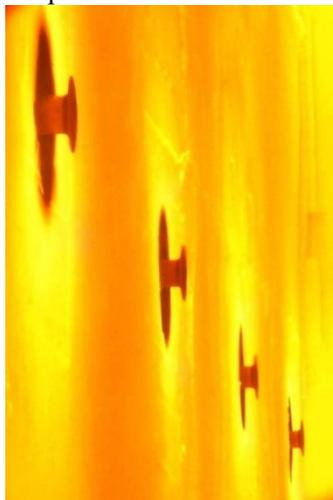
Рисунок 1. Работа вихревых плоскопламенных горелок при испытании в печи и распространение факела по кладке печи
