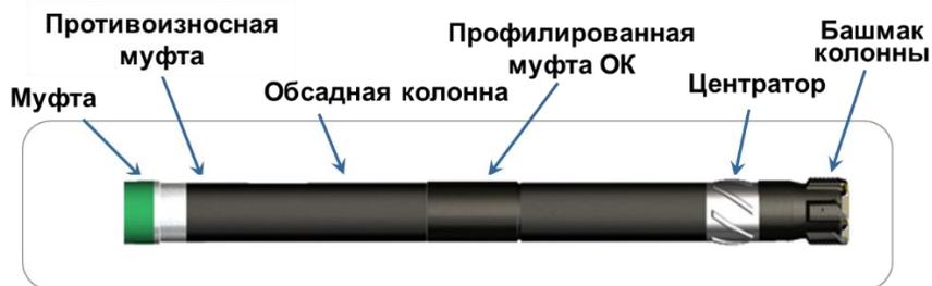
Рисунок 3. Схема компоновки обсадной колонны
