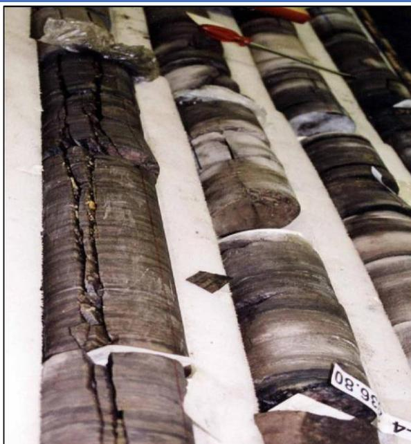
Рисунок 2. Образец поднятого керна из отложений рифея (ЮТ НГКМ, продуктивный пласт) (КрасНИПИнефть, 2011)
