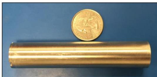
Рисунок 1 – Датчик для измерения ударных и вибрационных нагрузок
