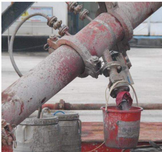
Рисунок 8. Схема отбора продуктов разрушения забоя
