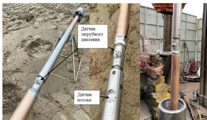
Рис.6 - Соединение деталей МЗВД в составе телеметрической системы
