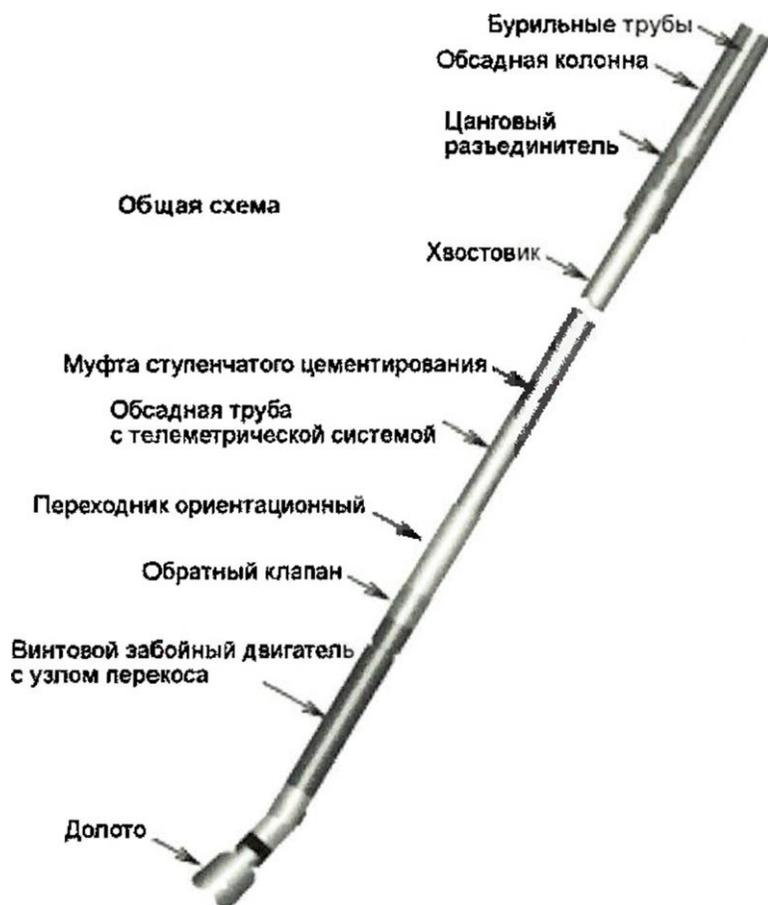
Рисунок 1. Неизвлекаемая управляемая компоновка для бурения на «хвостовике»
