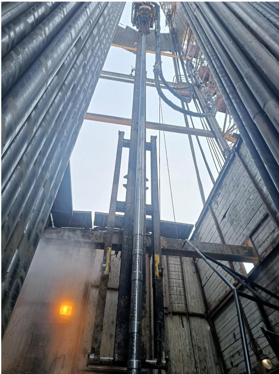
Рис.7 – КНБК в собранном состоянии
