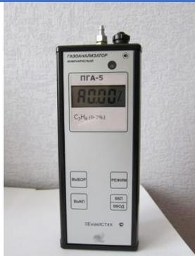
Рис.3. Инфракрасный газоанализатор ПГА-5
