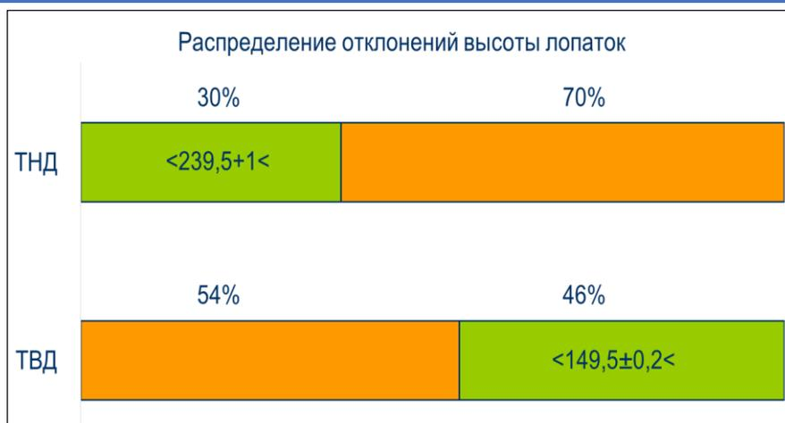
Рисунок 1 – Распределение отклонений высоты лопаток
