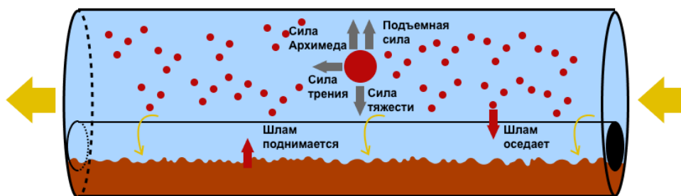
Рисунок 1 – Силы, действующие на частицу шлама
