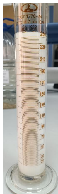
Рисунок 3. Выделение пены в результате действия пенокислотной шашки
