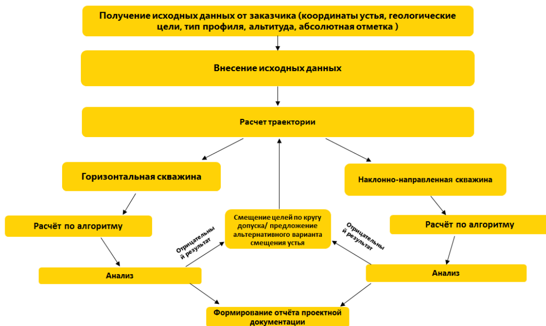
Рис. 8 Блок-схема алгоритма расчета профиля скважины в ПК «РН-Буровые расчеты»
