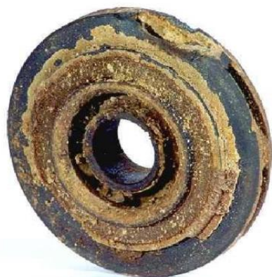
Рисунок 2. Солеотложения на рабочих колесах ЭЦН
