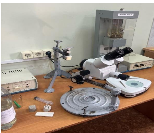
Рис. 4. Установка для измерения краевого угла смачивания
