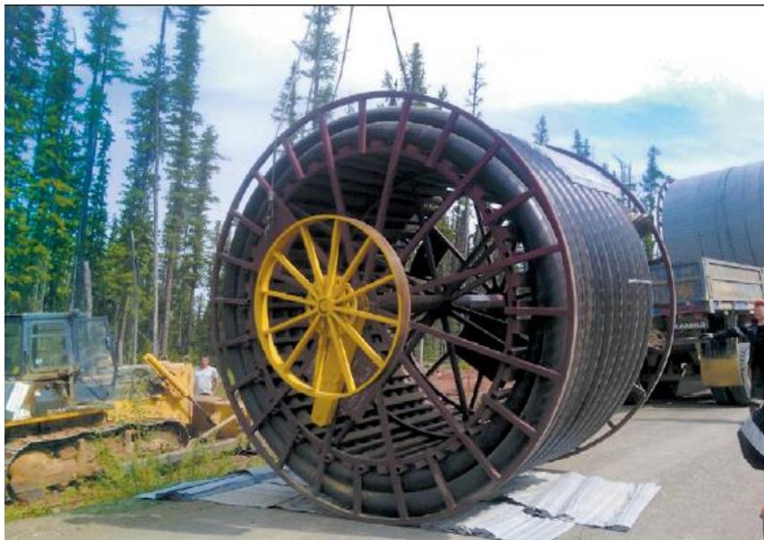
Рисунок 3 – сборка ПАТ на транспортировочном барабане
