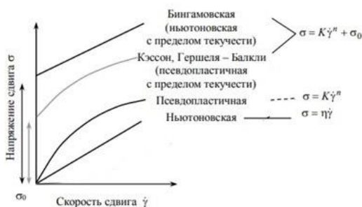
Рис.1. Кривые течения жидкостей, подчиняющихся разным моделям течения. [5]
