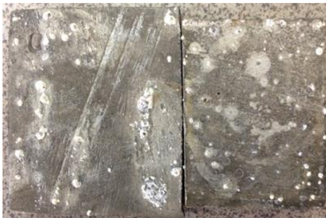
Рисунок 1 – Образование грибков на поверхности алюминия после 12 часов эксперимента
