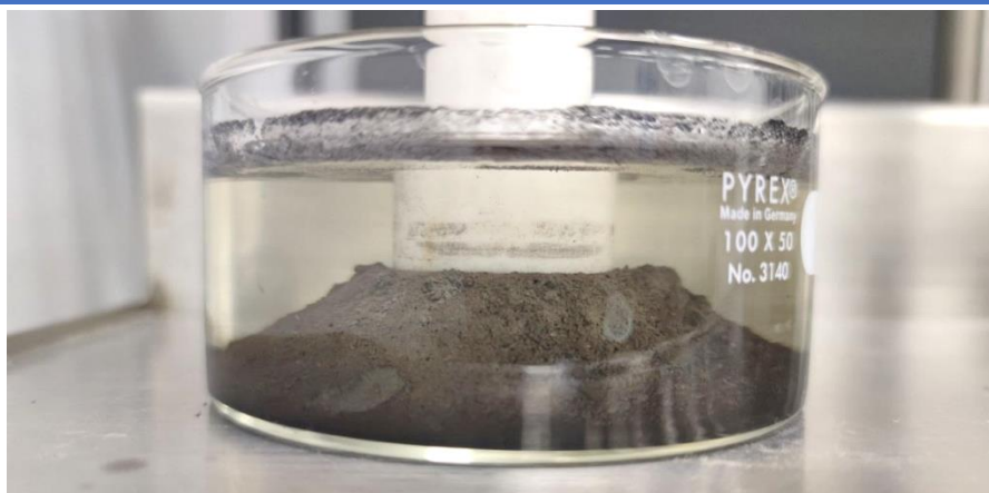
Рис. 4 - Искусственный образец обвальная породы после исследования в 1% растворе органофильного лигнита
