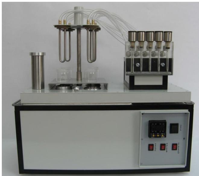
Рисунок 1 – установка для реализации метода холодного стержня
