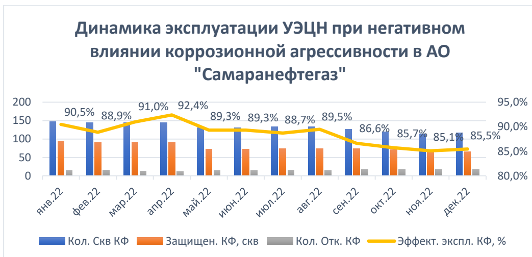
Рисунок 1. Динамика эксплуатации УЭЦН при негативном влиянии коррозионной агрессивности в АО "Самаранефтегаз"
