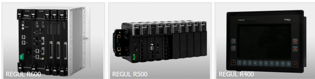
Рисунок 2- Линейка модулей REGUL RX00 производства Российской компании «Прософт-Системы»
