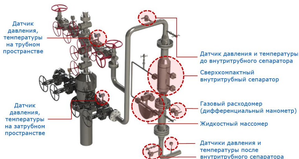
Рисунок 1. Общий вид скважины с внутритрубным сепаратором.
