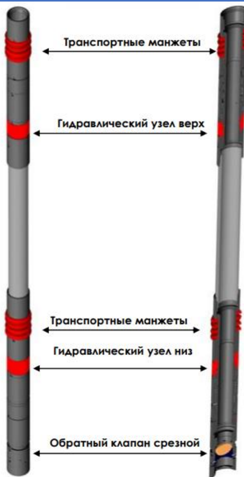
Рисунок 2 Схема устройства изоляции негерметичности НКТ
