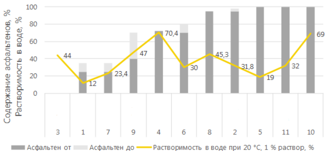
Рисунок 2 – Анализ влияния содержания асфальтенов на растворимость в воде
