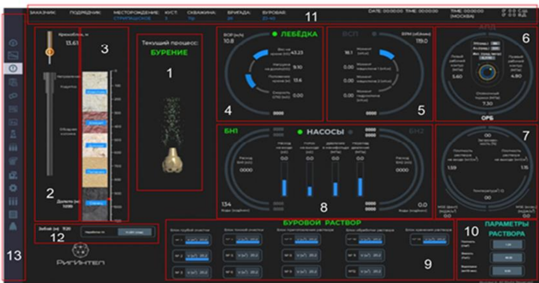
Рисунок 3. - Меню и навигация информационно-измерительной системы, контроля процесса бурения IR-MASTER 2.0, 1 – область визуализации текущего процесса; 2 – конструкция скважины; 3 – геология скважины; 4 – блок «Лебёдка»; 5 - блок СВП; 6 – область осцилляции, АПД, тормозов лебёдки; 7 – область дополнительных параметров раствора; 8 – область параметров насосного оборудования; 9 – область емкостей бурового раствора; 10 – параметры бурового раствора; 11 – основные данные по объекту; 12 – наработка талевого каната; 13 – главное меню программы
