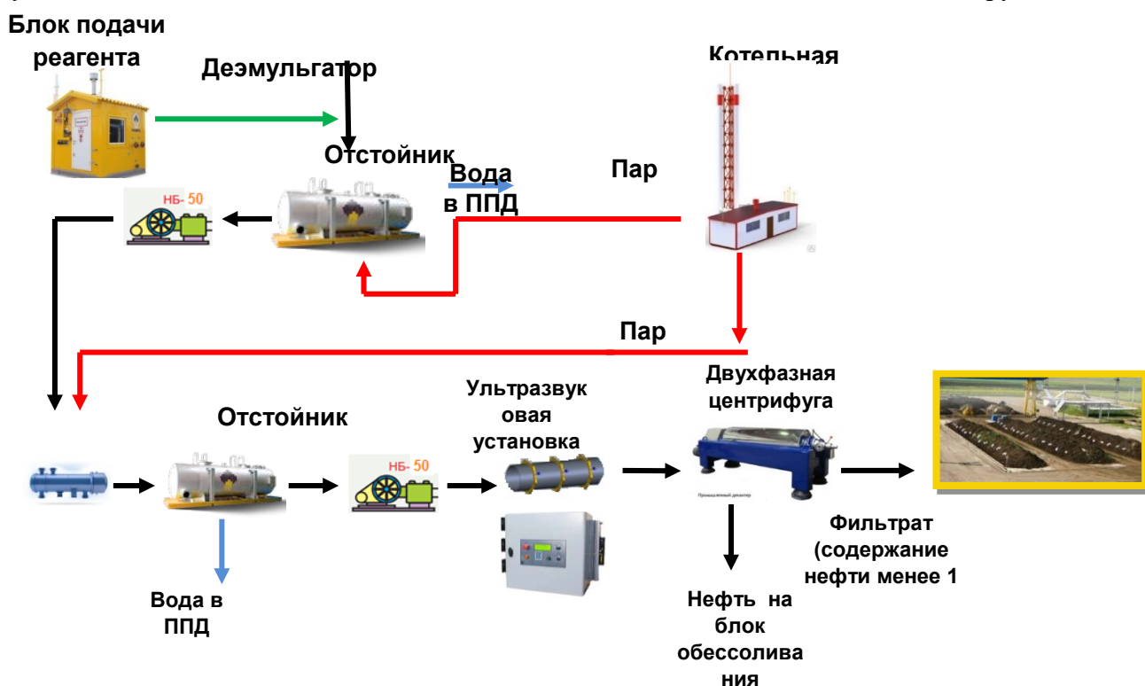
Рис.1. Технологическая схема по подготовке устойчивых эмульсий на УПН «Радаевская».
