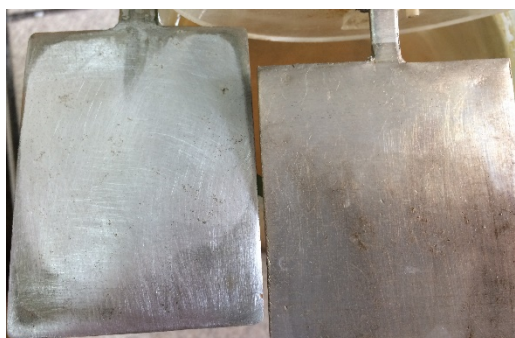
Рис. 2. Внешний вид испытуемых образцов слева – сталь, справа - алюминий
