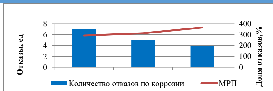
Рис. 1 - Отказы НГПО по коррозии и их доля от всех аварий на скважинах
