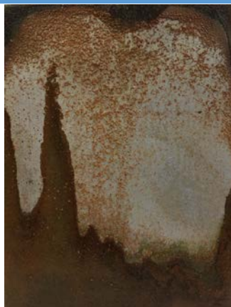
Рис. 5. Поверхность образца стали после 12 суток эксперимента
