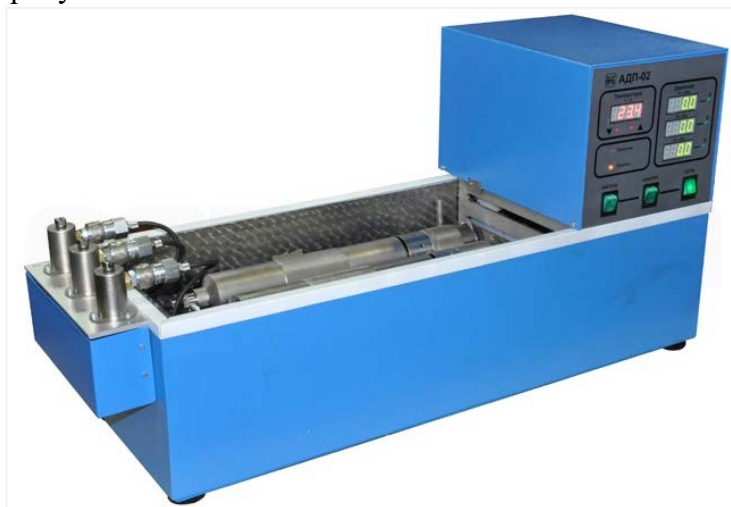
Рис. 2 – Аппарат АДП-02 для определения давления насыщенных паров
