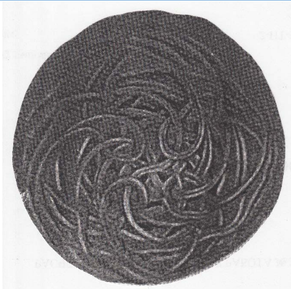
Рис. 1. Фотография забоя одношарошечного долота 7В 140Т при бурении в песчанике
