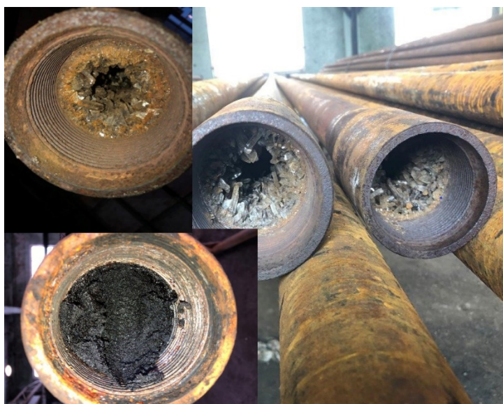
Рис. 1. - Твердые отложения на стенках насосно-компрессорных.
