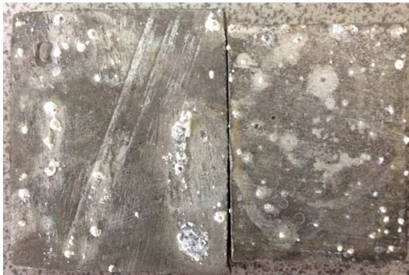
Рис. 1. Поверхность образца алюминия после 12 часов эксперимента
